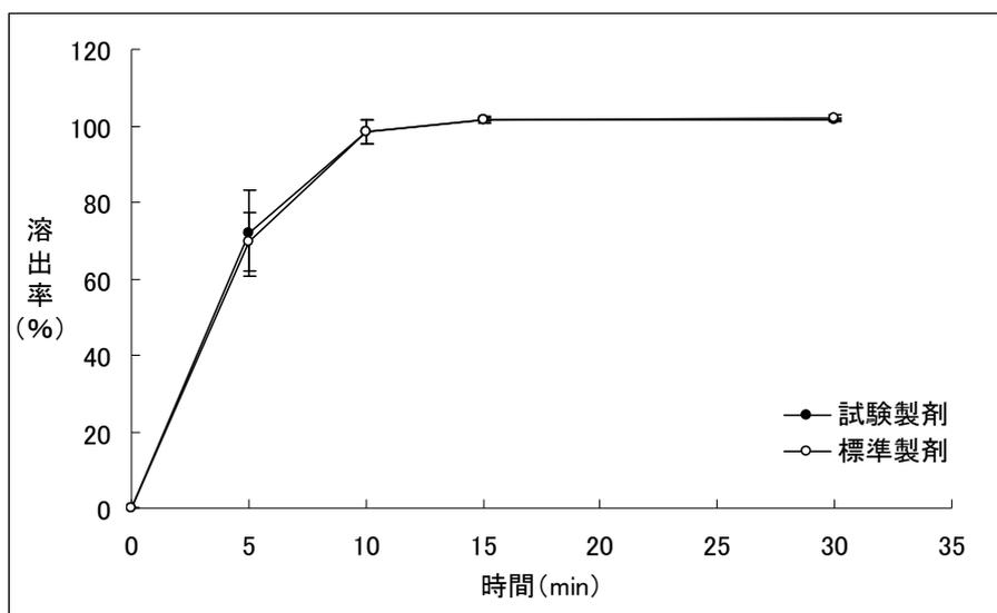
(4) 水、50rpm における各製剤の平均溶出率
