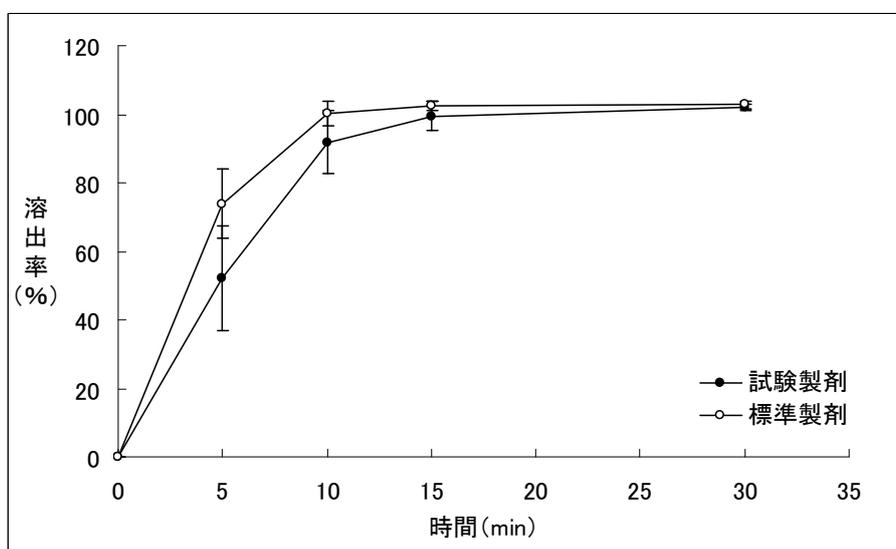
(5) pH1.2、100rpm における各製剤の平均溶出率
