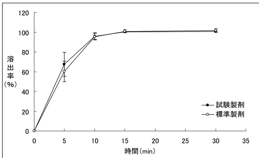
(3) pH6.8、50rpm における各製剤の平均溶出率
